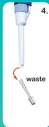
4. 弹出处理 移液器吸头 和FLOWMI 过滤器
