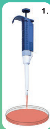
1. 将样品吸入 1000 \mu l移液器 吸头
