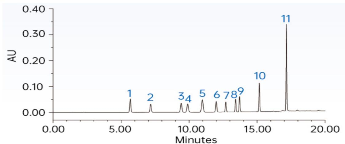
**检测物质：** 1. 苯酚 2. 4-硝基苯酚 3. 2-氯苯酚 4. 2-硝基苯酚 5. 2,4-二甲基苯酚 6. 2,4-二硝基苯酚 7. 4-氯-3-甲基苯酚 8. 2,4-二氯苯酚 9. 2-甲基-4,6,二氯苯酚 10. 2,4,6-三氯苯酚 11. 五氯酚
